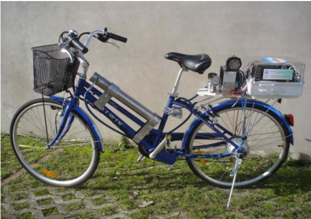
Bicicletta a pedalata assistita con alimentazione da cella a combustibile
