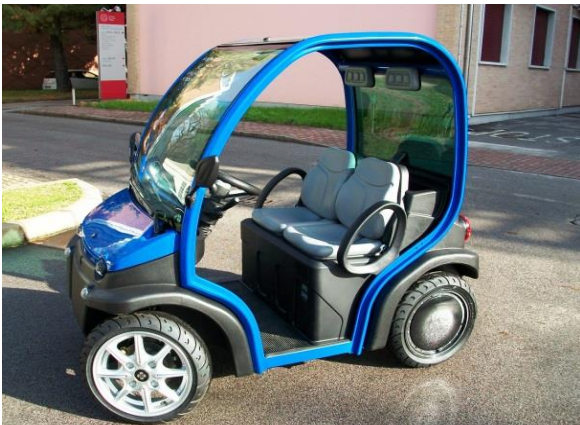
Minicar elettrica con sistema di alimentazione mista accumulatori al piombo-supercondensatori
