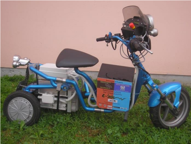
Veicolo rollante a tre ruote con motori ruota posteriori ed accumulatori agli ioni di litio
